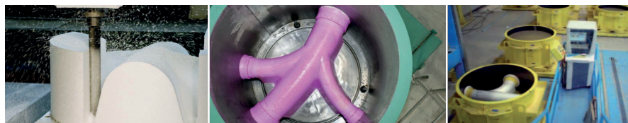
17. ábra: Negatív forma kialakítása EPS-ből robottechnológiával + öntömörödő beton [32]
